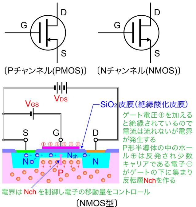
電荷を運ぶキャリアはトランジスタ同様 P型がホールで N型は電子
