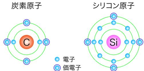
電子軌道は原子核を中心に内側から第1軌道、第2軌道とすると各軌道の電子の最大数は $2n^2$ である。最も外軌道の電子(価電子)は、ある程度の熱、光、電界エネルギーを与えると移動し始める。
